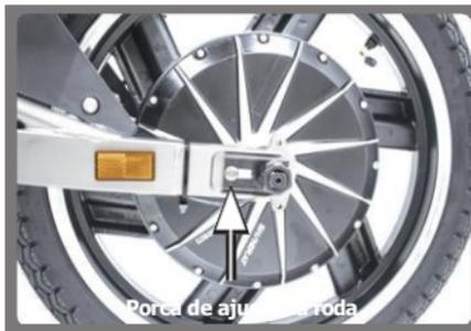
9. Remova a porca do eixo do freio traseiro e os parafusos da pinça de freio. Então, remova a roda, junto com o motor e seus cabos.
